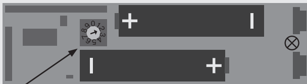
Selettore rotativo per l'angolo di sgancio
